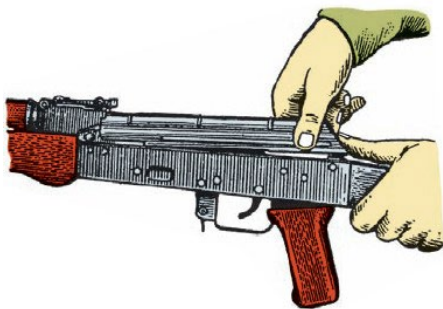
8. Отделение крышки ствольной коробки
