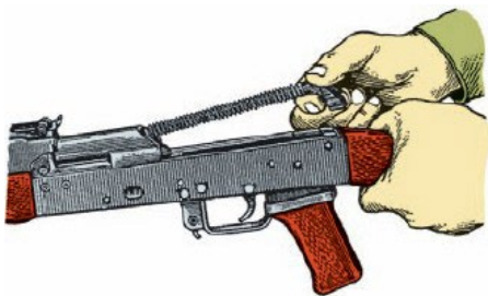
Рис. 9. Отделение возвратного механизма
